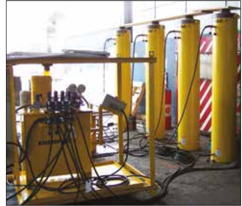
▲ Vérins 500 tonnes double-effet à course de 1,83 m pour levage de pelles électriques à câbles.
